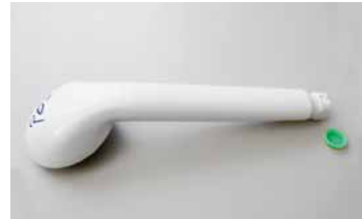
Fig. 4: Sparbrause mit Mengenbegrenzer (grün), Durchfluss 6 l/min bei 3 bar Fließdruck.
