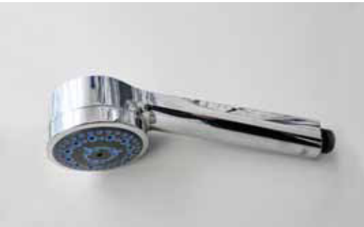
Fig. 2: Komfortbrause, Durchflussklasse C, 27 bis 30 l/min bei 3 bar Fließdruck, EN 1112 [3].
